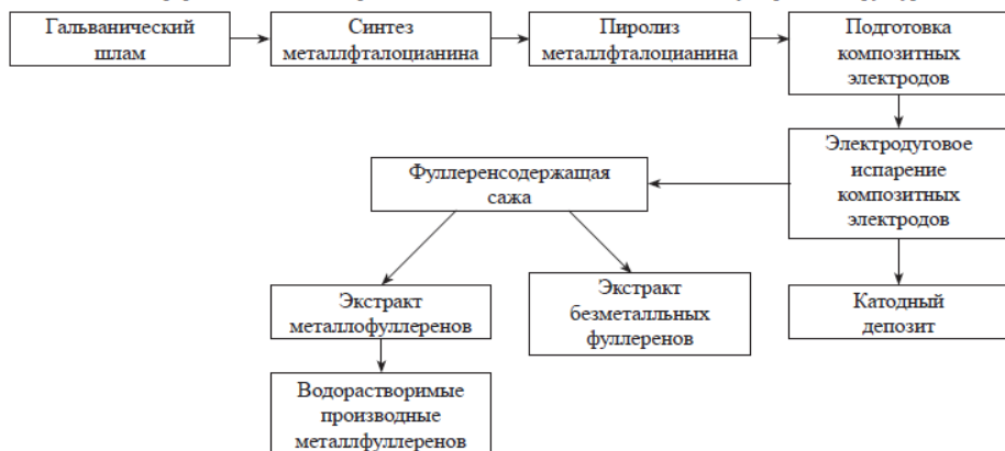
Схема переработки металлсодержащих гальванических шламов в металлоуглеродные структуры
